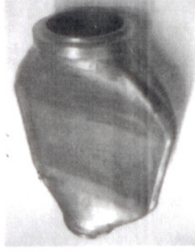
(그림 8) 중임 유로 조절 부품 : 양끝을 후속 물렌지로 고정하고 중간부는 변형하기 쉬운 20장의 얇은 격벽판으로 구성되어 있다
