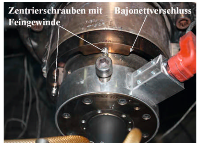
Bild 3. Im Betrieb befindliche Kippdüse, die zur feinfühligsten Zentrierung mit Feingewindeschrauben ausgerüstet ist
