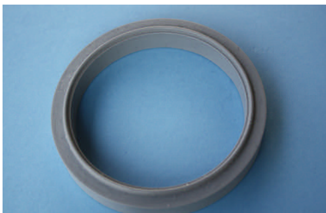
Bild 1. Dichtung des in Bild 5 dargestellten Kopfes (Dauer-temperaturbeständigkeit von 300 °C), mit der die Trennebene zwischen dem Kopf und der Düse abgedichtet wird und ein Kippen und ein Verschieben der Düse ermöglicht
