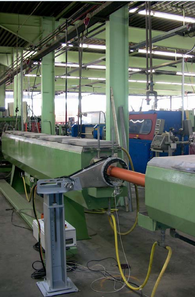
Bild 4. Neuartiges Messsystem zur Online-Erfassung der Wanddicken von kompakten oder auch kerngeschäumten Rohren, das hinter dem ersten Vakuumtank in die Rohrlinie integriert wurde (Foto: Ingenieurbüro Walz)
