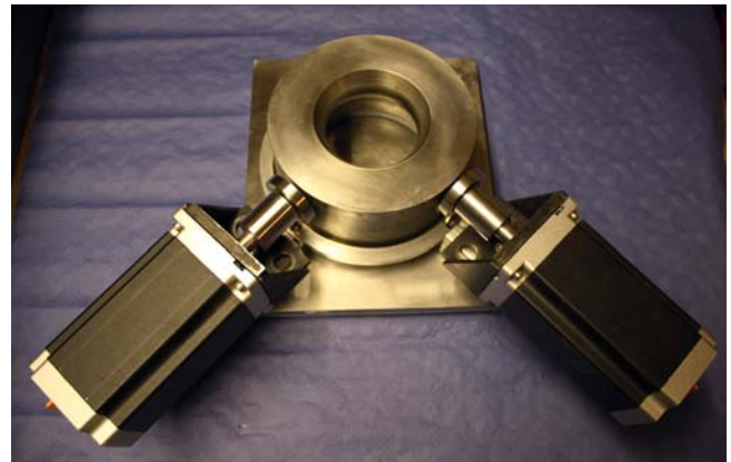
Bild 2. Kompletter auf einer Grundplatte montierter Umrüstsatz für einen vorhandenen Blaskopf, bei dem mittels zweier Schrittmotoren jede benötigte Position der Düse relativ zum Dorn mit höchster Präzision realisiert werden kann
